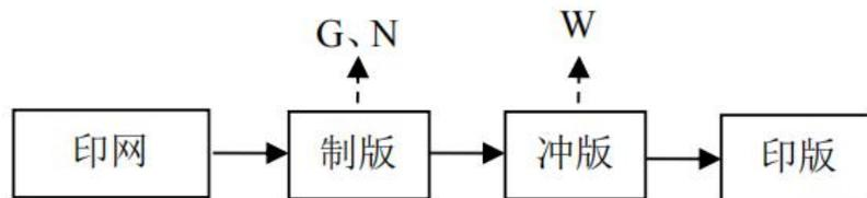
图 3-4 制版生产工艺及产污环节图
