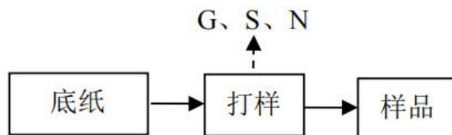
图 3-5 打样生产工艺及产污环节图
