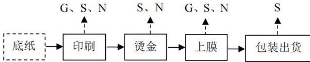
图 3-3 花纸生产工艺及产污环节图
